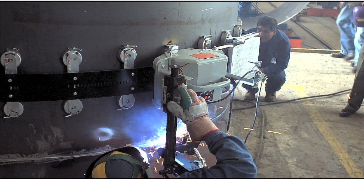
4-WEGE BRENNERHALTERUNG Zum Anbau an horizontalen Zahnstange des KAT, bietet 127 mm vertikalen Verstellweg, 360° Freiheit in der Drehung & zwei Freiheitsgrade für den Anstellwinkel.
